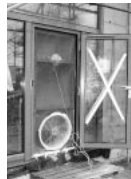
Abb. 9: Prüfung der Luftdichtheit im April 2000: n_{50}=0,4 \text{ h}^{-1}
